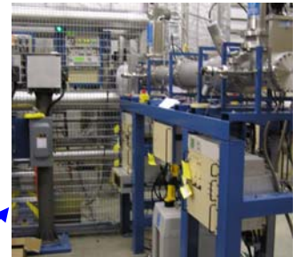
400 kV ion implanter in MIBL
