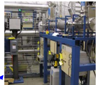
400 kV ion implanter in MIBL
